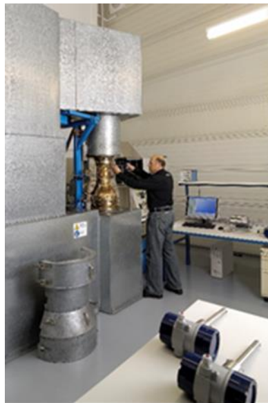
Hochtemperatur-Strömungs-Prüfstand HTP in geschlossener Bauweise „Universität Stuttgart“
