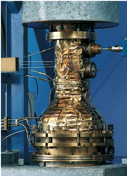
Hochtemperatur-Strömungs-Prüfstand HTP in geschlossener Bauweise „Universität Stuttgart“
