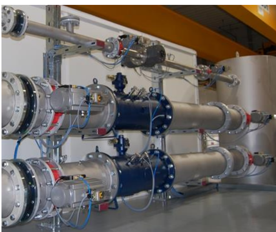
Atmosphärischer Volumenstrom-Prüfstand AVP
