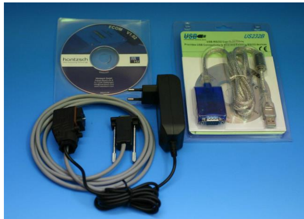
Abb. 1: Programmieradapter GO 70 / RS232 für Software UCOM, Anschluss PC Sub-D 9-polig, Steckernetzteil 230 VAC/24VDC und USB-Adapter
