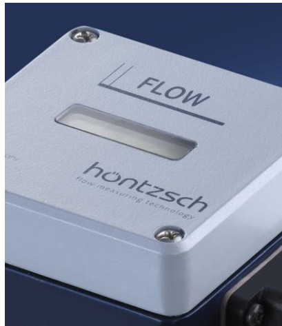
Abb. 2: optionale LCD-Anzeige im Gehäusedeckel
