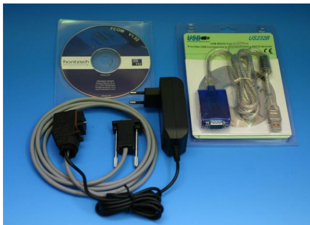
Abb. 1: Programmieradapter GO 70 / RS232 für Software UCOM, Anschluss PC Sub-D 9-polig, Steckernetzteil 230 VAC/24VDC und USB-Adapter
