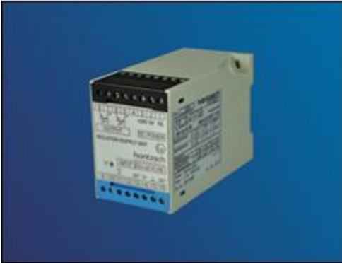
Das Trenn-/Speisegerät LDX2 ist als zugehöriges elektrisches Betriebsmittel ausgeführt, an das eigensichere Strömungssensoren VA und FA von Höntzsch angeschlossen werden dürfen. Der Betrieb ist nur außerhalb des Ex-Bereiches zulässig. Es dürfen nur zugelassene eigensichere Strömungssensoren VA und FA angeschlossen werden, deren sicherheitstechnische Höchstwerte den technischen Daten des LDX2 entsprechen.
