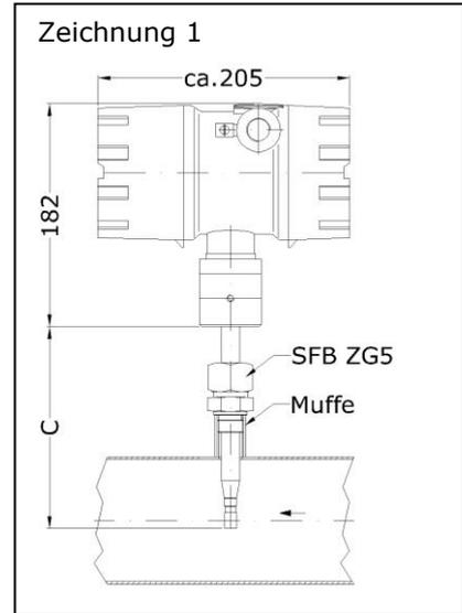
Anschluss an bauseitige Muffe mit Innengewinde
