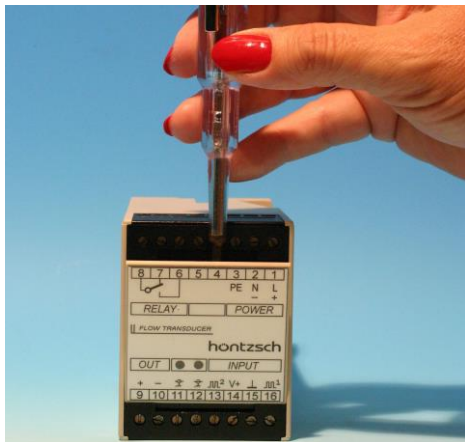
Abb 1: Frontabdeckung mit Schraubendreher entfernen
