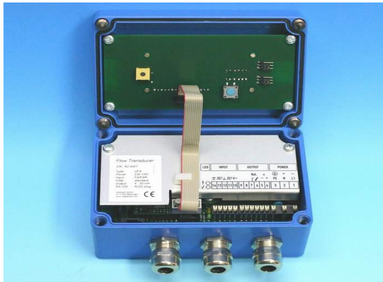
Abb. 2: Anschluss LCD-Anzeige bei geöffnetem Gehäusedeckel
