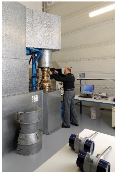
Hochtemperatur-Strömungs-Prüfstand HTP in geschlossener Bauweise „Universität Stuttgart“
