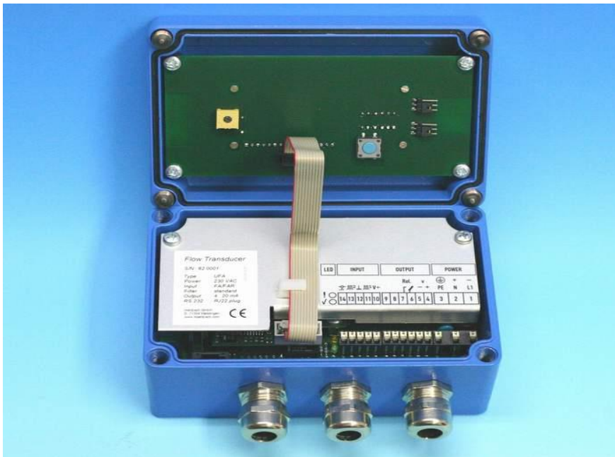
Abb. 2: Anschluss LCD-Anzeige bei geöffnetem Gehäusedeckel
