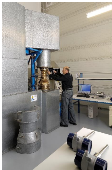
Hochtemperatur-Strömungs-Prüfstand HTP in geschlossener Bauweise „Universität Stuttgart“
