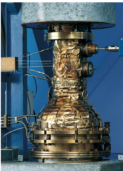
Hochtemperatur-Strömungs-Prüfstand HTP in geschlossener Bauweise „Universität Stuttgart“
