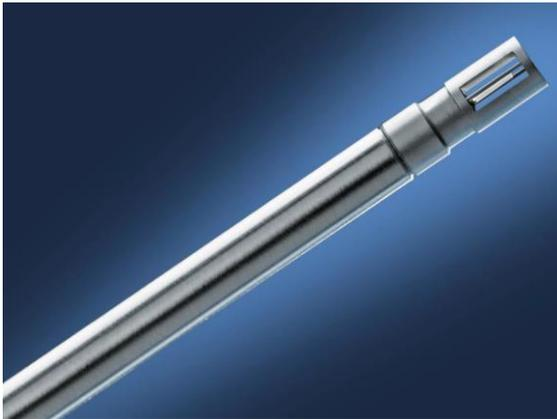
Les capteurs TA10 / TA Di en version Ex sont des équipements électriques simples, et qui, associés à un amplificateur d'alimentation intrinsèque de classe de protection **Ex ib**, mesurent la vitesse d'écoulement et la température de l'air et des gaz. Ils ont été conçus pour être utilisés dans les atmosphères dans lesquelles une composition gazeuse explosive risque occasionnellement de se produire en fonctionnement normal.
